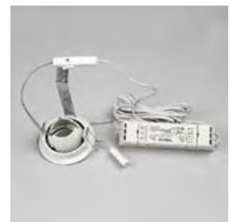
Montage über Montagefedern. Anschluss zwischen Leuchte und Transformator mit Schnellverbinder.
